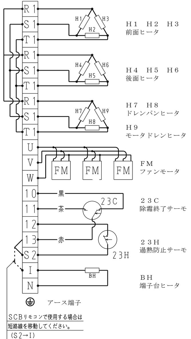
※図中の矢印は温度上昇時に接点が動作する方向です。
